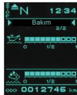
Yağ seviyesi Göstergede yağ seviyesine , araç düz bir zeminde dururken ve rölantide çalıştırdıktan yaklaşık 1 dakika sonra bakınız.
