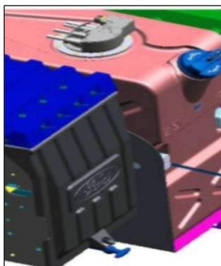
Si le réservoir est retirée, il doit être placée à l'intérieur du boîtier métallique dans sa position d'origine. Le couvercle de retenue doit être installé et les nouveaux boulons GC46-5J286-AB (2 pièces) doivent être serrés avec un couple de 80 Nm.
