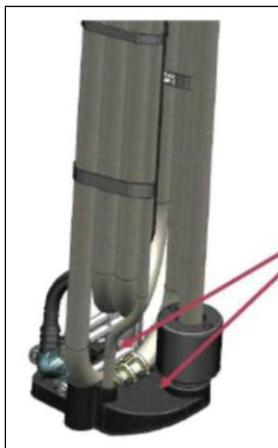
Retournez le flotteur. Tout d'abord, essayez de retirer les boulons avec un tournevis cruciforme. Si vous avez du mal à le retirer, chauffez le boulon indiqué par une flèche à l'aide d'un fer à souder pour éviter d'endommager les dents. Lors du chauffage avec un fer à souder, la pointe du fer à souder ne doit entrer en contact qu'avec le boulon. Il ne doit entrer en contact avec aucune autre zone.
