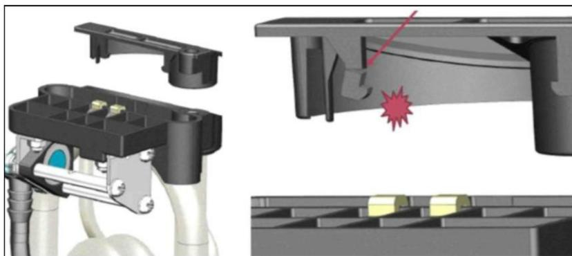
Après avoir retiré le filtre, un nouveau kit de filtre doit être installé sur la zone concernée. La procédure d'installation doit être effectuée comme indiqué sur la figure.
