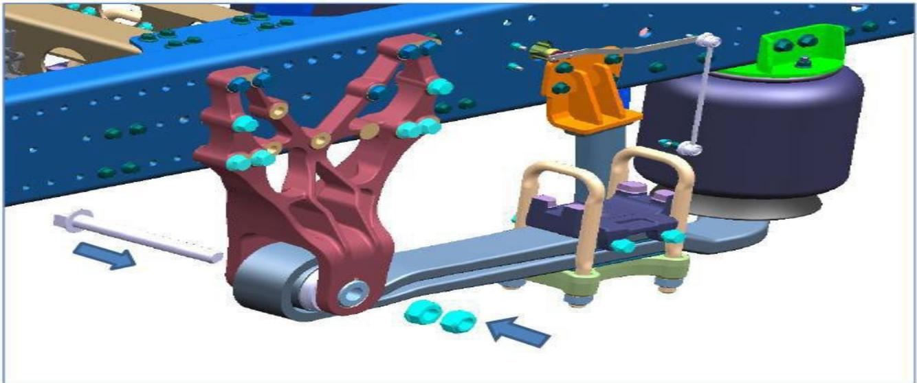
1.5. Tout en serrant la connexion, tenez la tête du boulon M30 et appliquez un couple sur les écrous. Les valeurs de couple sont de  $1000 \pm 75$  Nm pour le premier écrou et de  $500 \pm 50$  Nm pour le deuxième écrou, comme indiqué ci-dessous.
