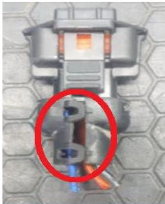
2- Les bornes 1 et 3 doivent être retirées qui se trouvent sur le connecteur de câblage.
