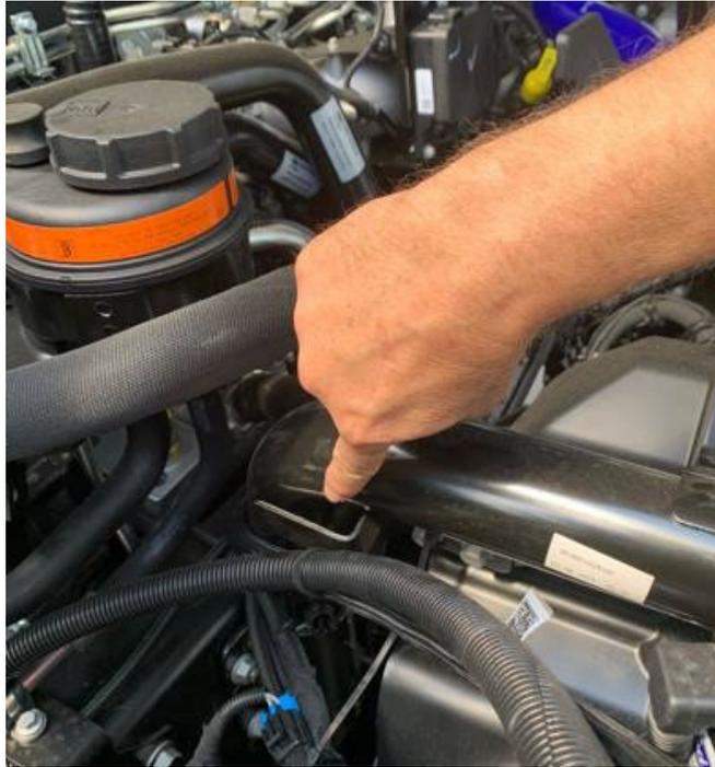
11- Installez le filtre à carburant (dans la fente, en vous penchant vers l'intérieur du véhicule). Branchez les prises.
