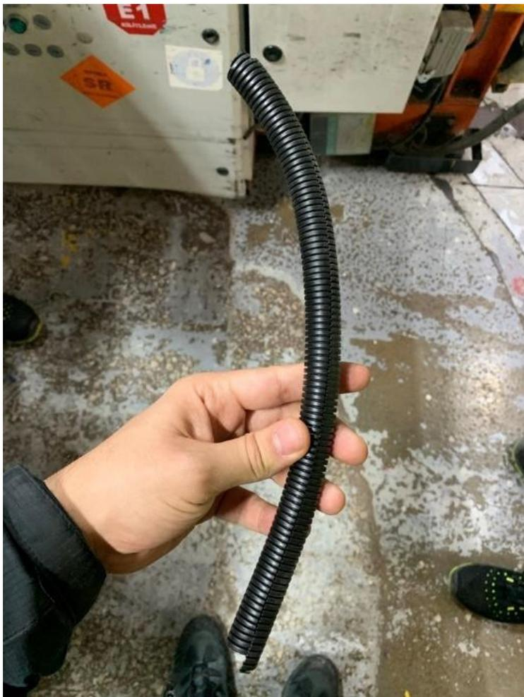
Figure 10 – Pièce GAF – 4C46-2254-BA – doit mesurer 15 cm de long
