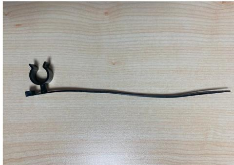
Figure 6 – Sangle C-Clip (MC46-14197-AA) à utiliser pour la réparation
