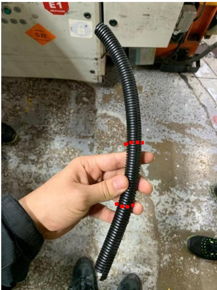
Figure 15 – GAINÉ – 4C46-2254-BA – doit mesurer 10 cm de long
