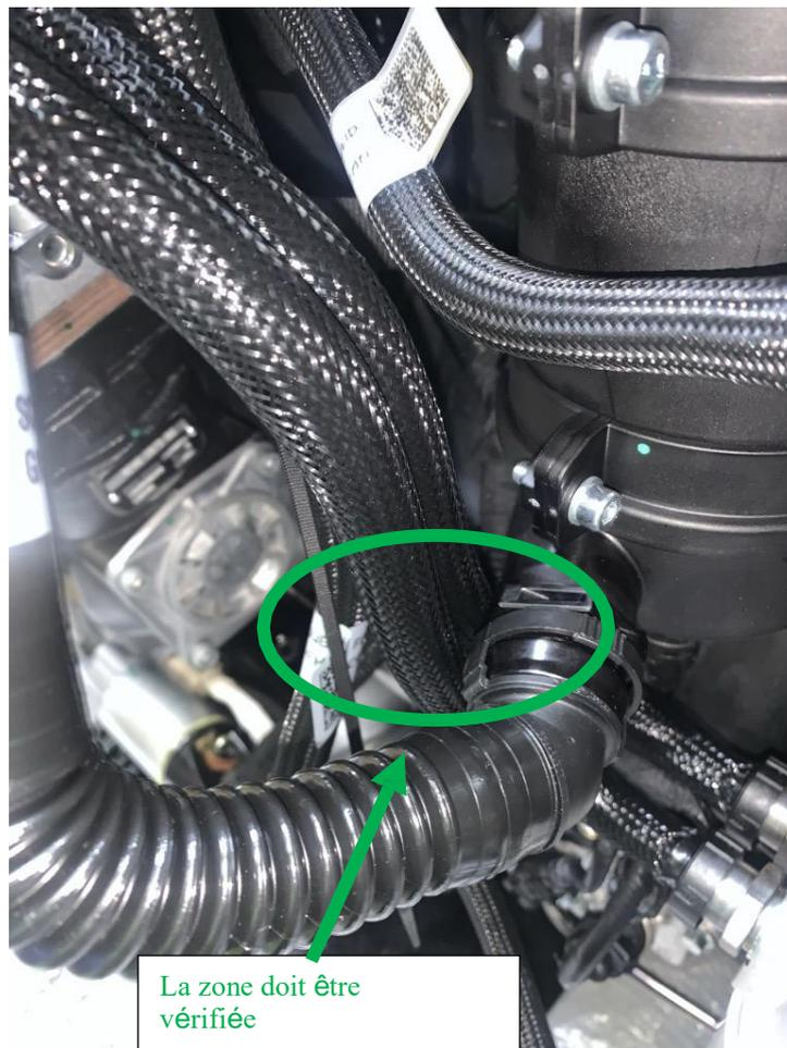
Figure 3 – Zone et tuyau approprié pour la vérification de la conduite de carburant
