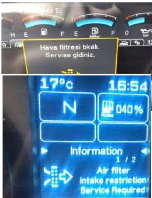
Ce TSB est préparé pour les véhicules qui viennent à l'entretien avec l'avertissement « Restriction de l'admission du filtre à air, entretien requis ». Lorsque ce mode d'erreur est rencontré, les filtres à air des véhicules doivent d'abord être vérifiés visuellement.
