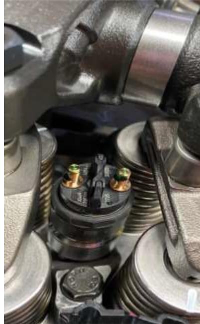
9- Les 12 écrous d'injecteur doivent être serrés à 2,5 Nm
