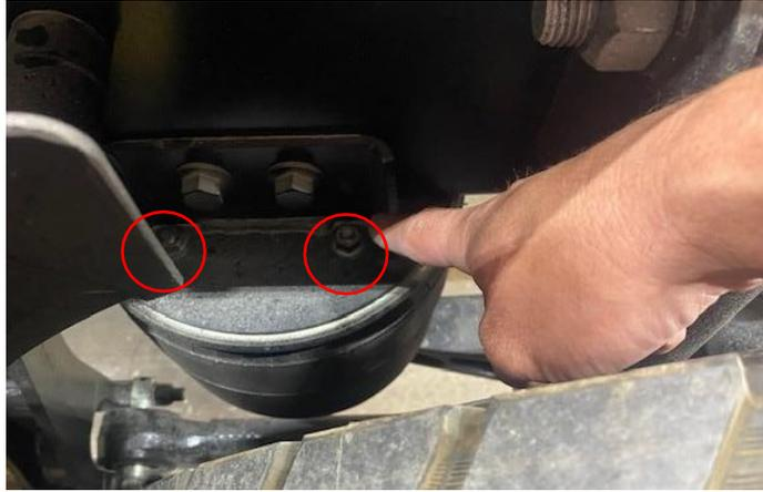
Retirez le boulon du boîtier de pédalier, puis retirez le coussin pneumatique de suspension arrière C4AS. Installez un nouveau coussin pneumatique de suspension arrière C4AS (DC46 5580 DB).
