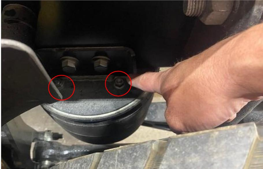
Retirez le boulon du boîtier de pédalier, puis retirez le coussin pneumatique de suspension C4AS avant. Installez un nouveau coussin pneumatique de suspension C4AS avant (DC46 5580 CB).
