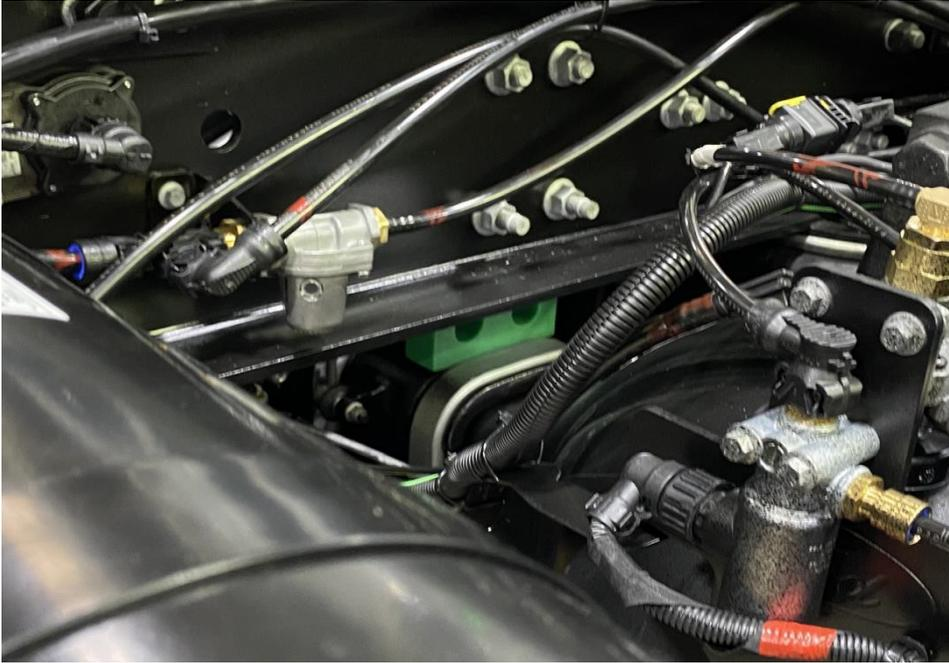
Retirez le raccord d'air du coussin pneumatique de suspension avant C4
