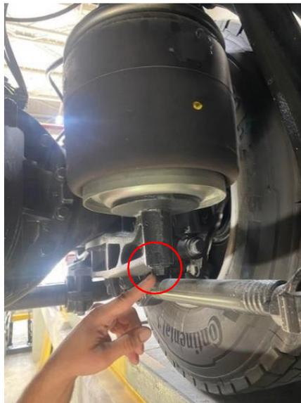
Installez le connecteur et les capteurs de pression un par un et assurez-vous que le connecteur est correctement branché.
