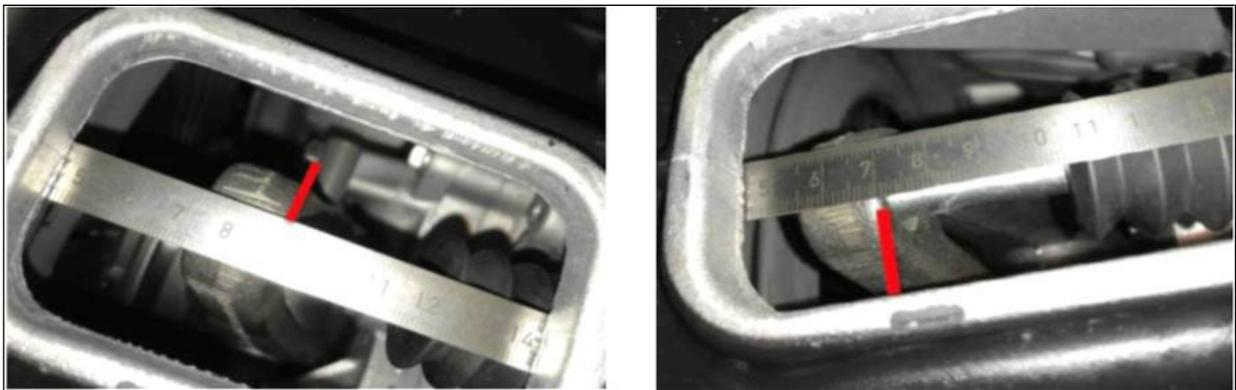
Image 12 - Distance de mouvement de la fourche d'embrayage par rapport au carter du volant
