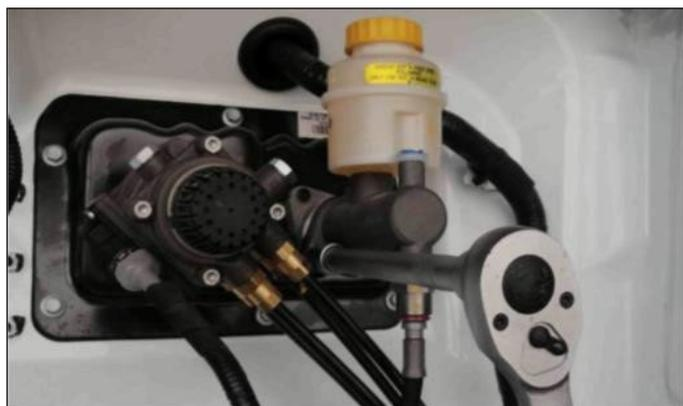
Image 3 - Boulons du maître-cylindre d'embrayage
