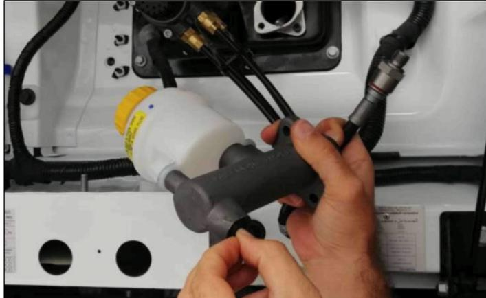
Image 7 - Bouchon du maître-cylindre d'embrayage
