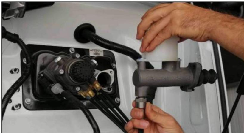
Image 6 - Raccordement du tuyau hydraulique et du maître-cylindre d'embrayage
