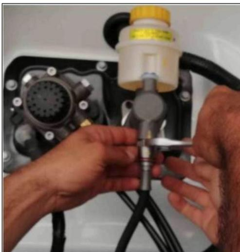
Image 2 - Tuyau hydraulique du maître-cylindre d'embrayage
