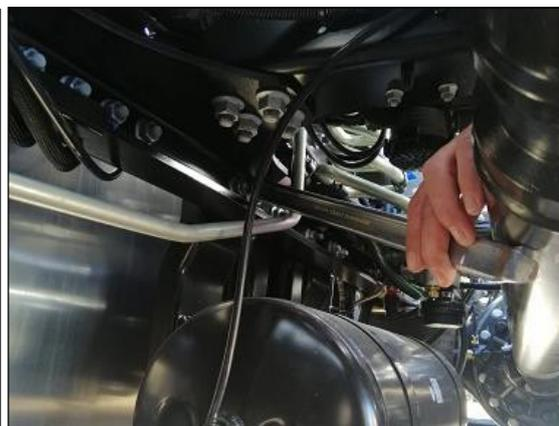
Après le processus de glissement, assurez-vous que la distance entre les deux extrémités du tuyau qui seront montées est de 290-295 mm et que tous les assemblages de supports doivent être terminés en serrant les boulons à 10 Nm.
