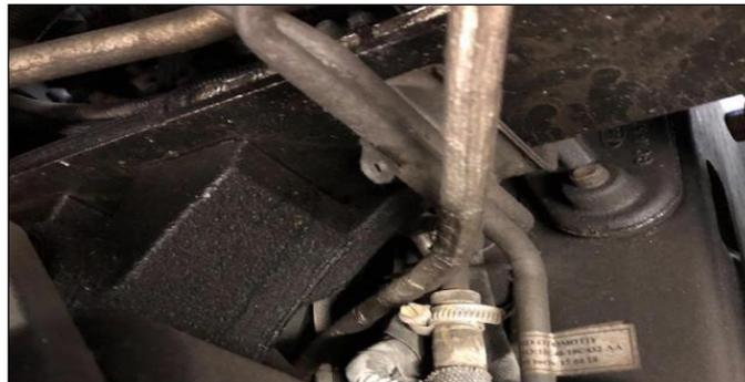
6- L'application du manchon de protection doit commencer à l'endroit où le support marqué se termine dans le châssis et se poursuivre dans la cage SCR, y compris le boulon du support de la lame de ressort.
