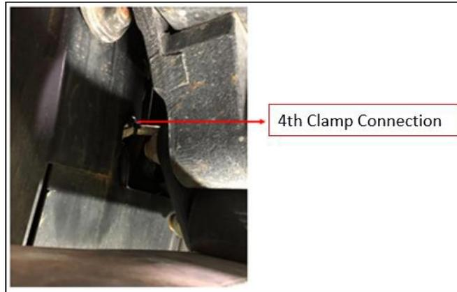
5- Lorsque le tuyau s'est détaché des colliers et qu'il est relâché, il doit être tiré vers le support approprié et la mise en œuvre du manchon de protection doit être appliquée.
