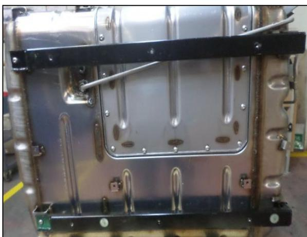
17- Serrez 6 boulons (**W505541 S437**) sur le bouclier thermique latéral (**GC46-5K277-AA**) à **25+/-4 Nm** à l'aide d'une clé Allen 6"
