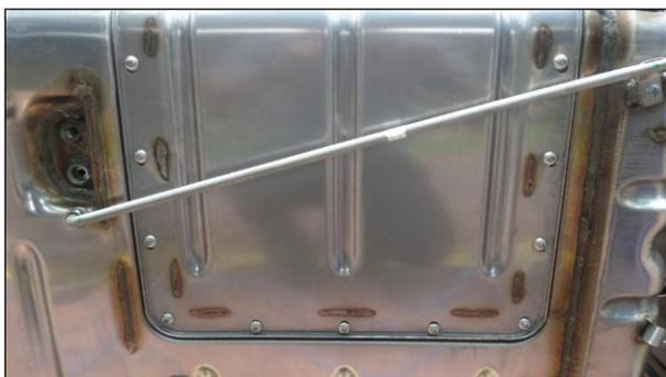
16- Installez 2 supports de suspension (**GC46-5A277-AA**) où est installé le bouclier thermique avec le logo Ford et 4 boulons (**W505541 S437**) dessus à l'aide d'une clé Allen 6" et serrez les boulons à **25+/-4 Nm**
