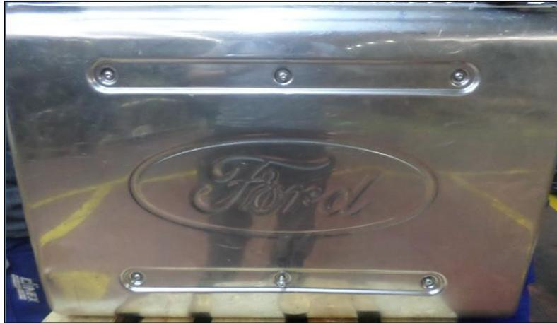
18- Serrez 9 boulons (W505541 S437) sur le bouclier thermique supérieur du silencieux (**GC46-5K277-BA**) à **25+/-4 Nm** à l'aide d'une clé Allen de 6".
