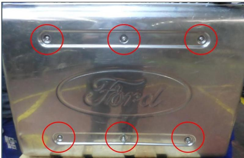
3- Retirez les 2 supports de suspension (**GC46-5A277-AA**) où le bouclier thermique est installé et les 4 boulons (**W505541 S437**) dessus à l'aide d'une clé Allen de 6" et retirez les supports du silencieux.
