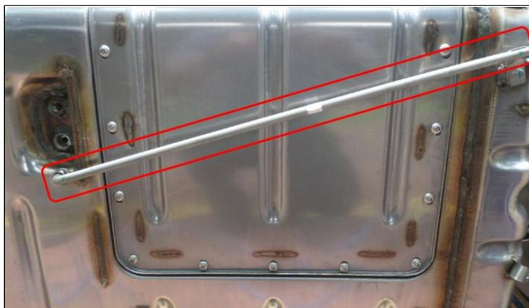
5- Retirez les 20 boulons du couvercle du DPF à l'aide d'une clé Allen de 5 po.
