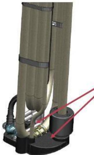
9- Retournez le flotteur. Tout d'abord, essayez de retirer la vis avec un tournevis cruciforme. Si vous avez du mal à retirer, chauffez la vis indiquée par une flèche à l'aide d'un fer à souder pour éviter d'endommager les dents. Lors du chauffage avec un fer à souder, la pointe du fer à souder ne doit entrer en contact qu'avec la vis. Il ne doit entrer en contact avec aucune autre zone.
