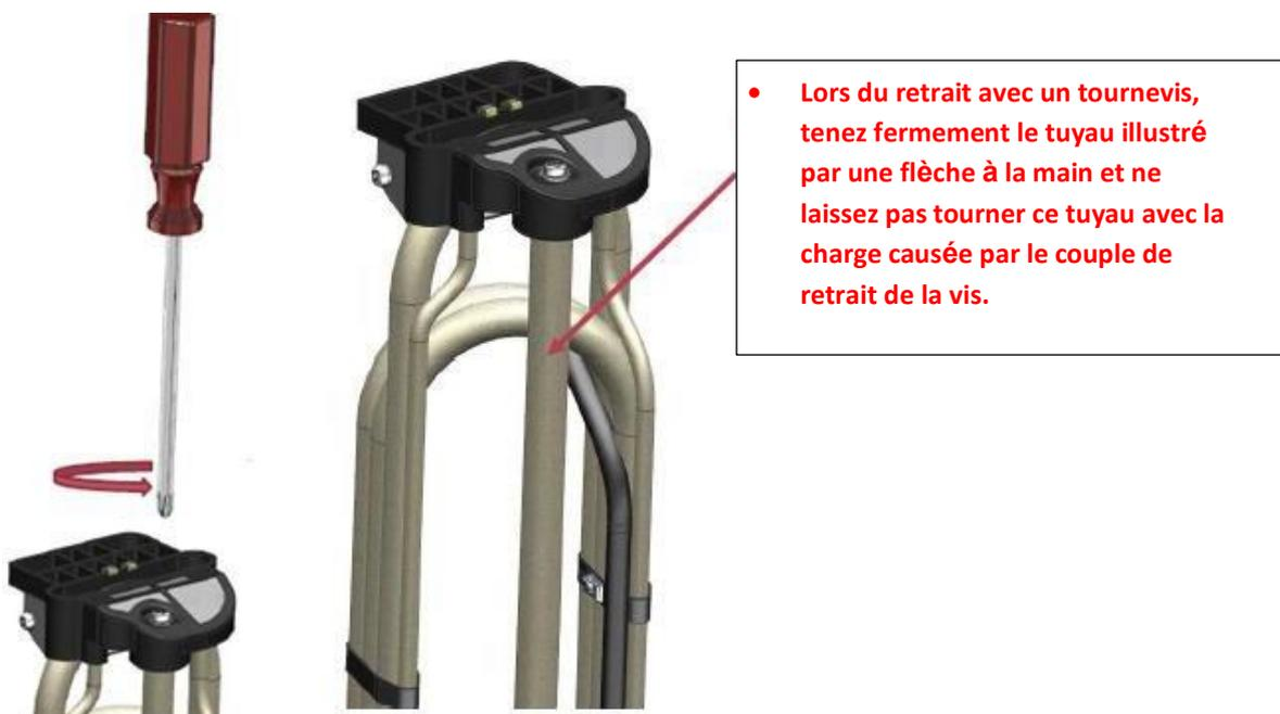
11-La vis et la rondelle élastique en dessous doivent être mises au rebut après les avoir retirées.
