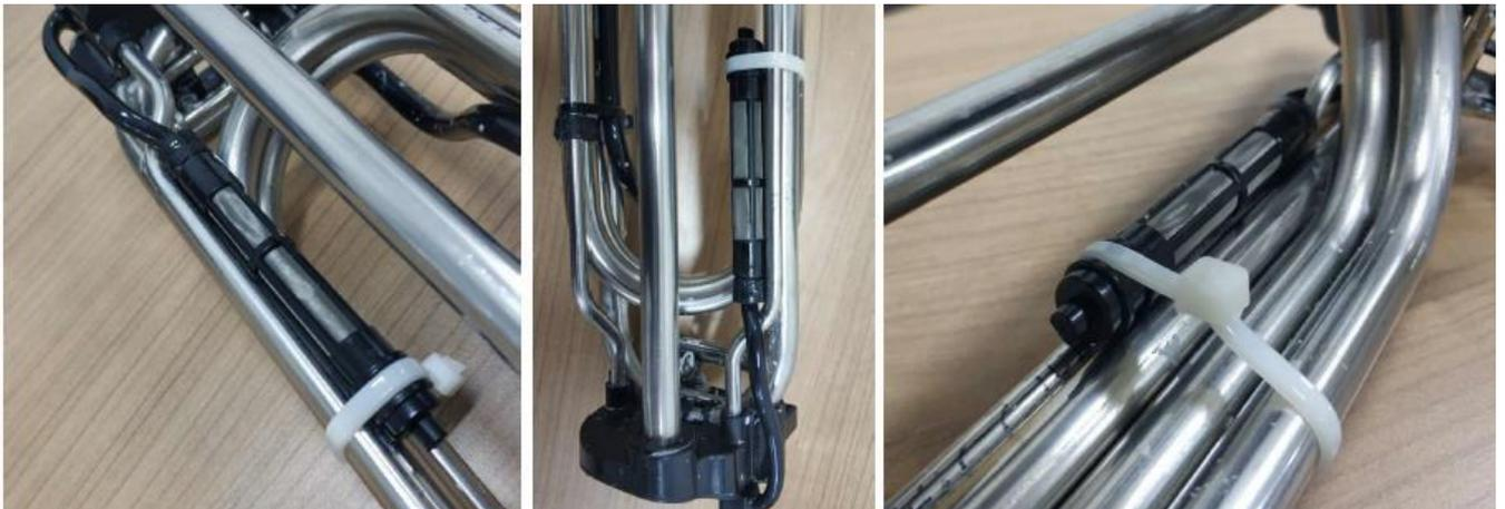
**20-**Après avoir effectué toutes les inspections et applications spécifiées ci-dessus, le flotteur doit être installé sur le réservoir. Le flotteur doit être installé sans endommager les tuyaux métalliques du flotteur et du filtre lors de l'installation du nouveau flotteur sur le réservoir. Assurez-vous que les joints toriques en caoutchouc du flotteur ne sont pas oubliés. Après l'installation, les extrémités de l'embout du flotteur doivent être verticales et faire face au cadre.
