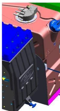
**21-** Si le réservoir est retirée, il doit être placée à l'intérieur du boîtier métallique dans sa position d'origine. Le couvercle de retenue doit être installé et les nouveaux boulons GC46-5J286-AB (2 pièces) doivent être serrés avec un couple de **80 Nm**.
