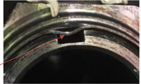
6. Après avoir pulvérisé Loctite 7070 sur les surfaces d'assise de l'essieu et du moyeu et l'avoir séché avec un chiffon propre, appliquez-le sur le moyeu comme sur la photo et installez l'essieu.
