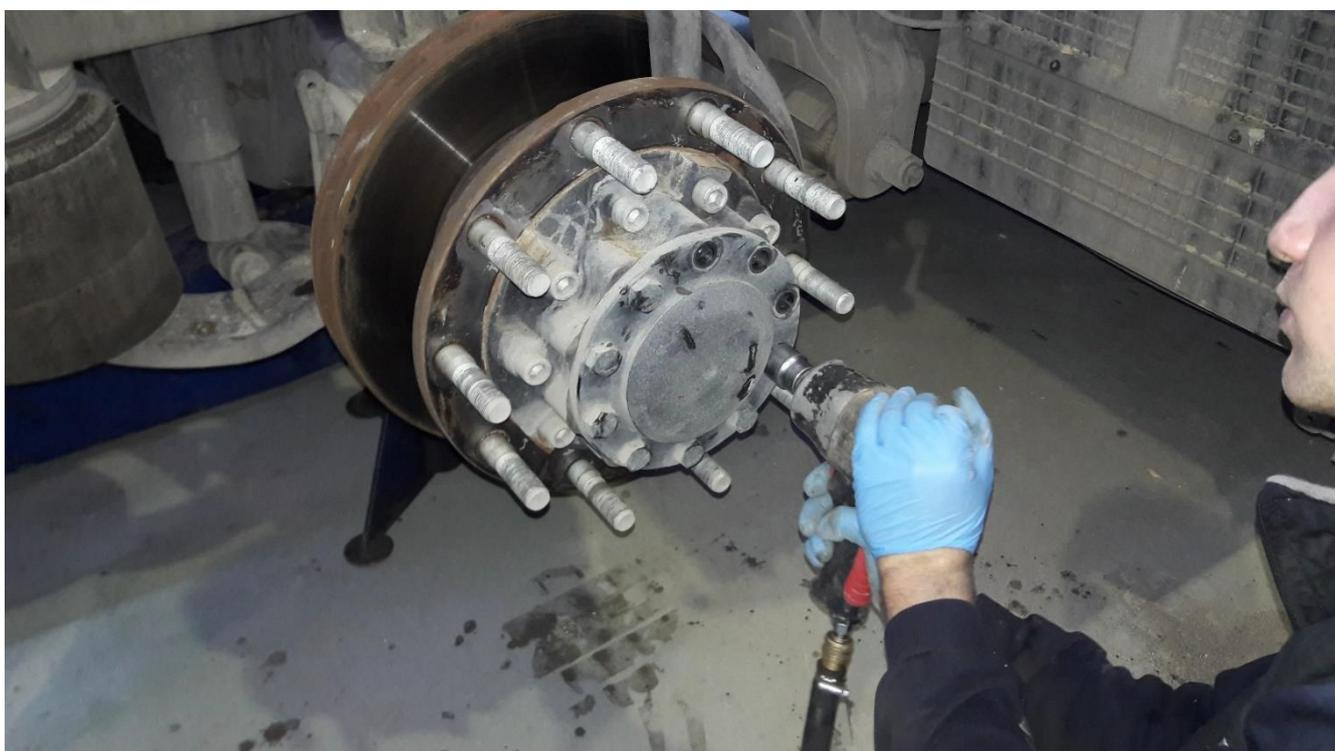
3. Retirez soigneusement le couvercle d'essieu à l'aide d'un tournevis, car des dommages sur les pièces peuvent entraîner des réclamations à l'avenir.
