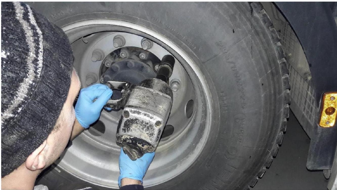
2. Retirez les 10 boulons de couvercle d'essieu M24.
