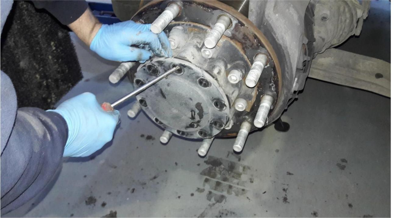
4. Retirez l'ancien écrou de moyeu de niveau et l'ancienne rondelle de niveau à l'aide de SST H050205-LA (outil spécial) qui peut être vu en bas à droite de la page. Écrou de moyeu de niveau ancien : HC46-1A124-AA (roue droite) / HC46- 1A125-AA (roue gauche) / Rondelle de niveau ancien : HC46-1124-BA
