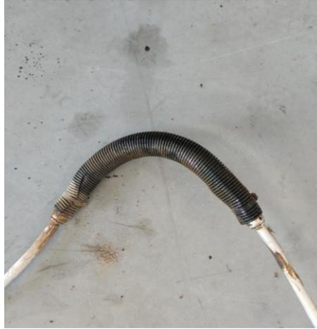
**Photo 3 -** Taches d'huile brune sur le tuyau
