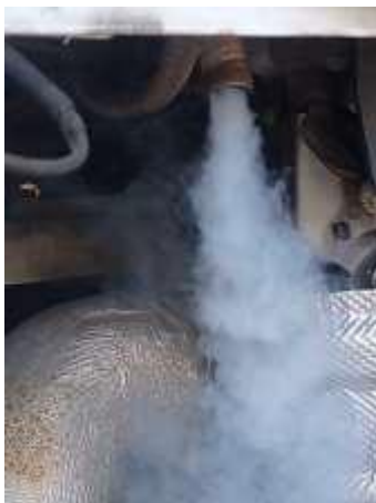
Image 1 - Fumée blanche sortant de l'échappement du radiateur.
