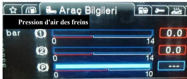
**Vérifiez si l'orifice d'échappement E-APU draine l'air en continu en dessous de 5,5 bars ou non**
