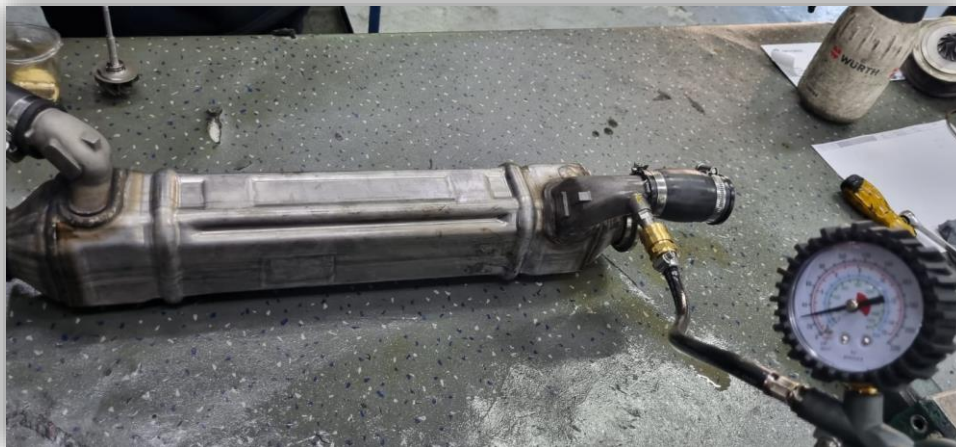
Photo 1 : Test de fuite d'air
