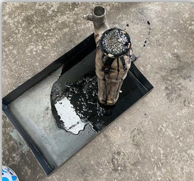
Photo 3 : Nettoyage du refroidisseur EGR avec NaOH
