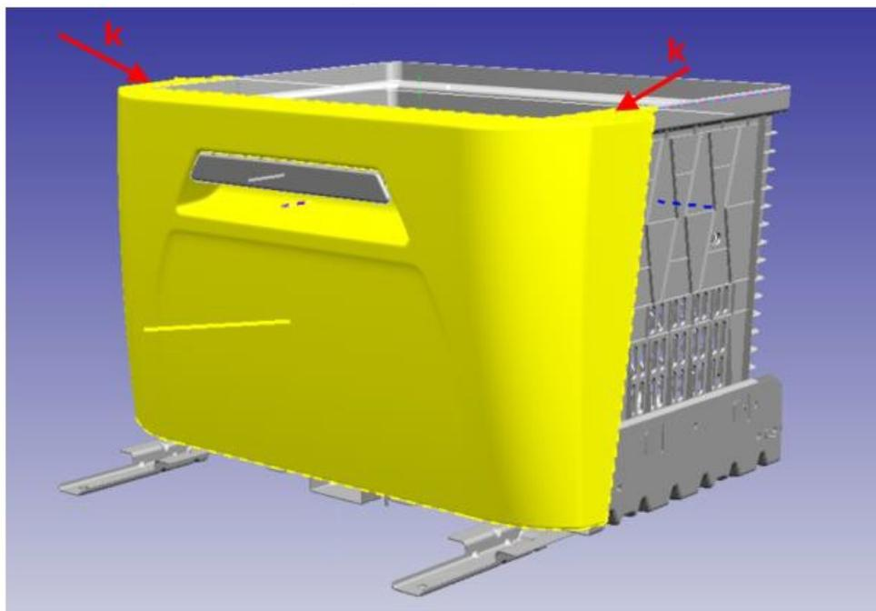
R : Utiliser un pistolet à air chaud afin de chauffer les parties indiquées par les flèches rouges sur la pièce jaune pendant 10 à 15 secondes.
