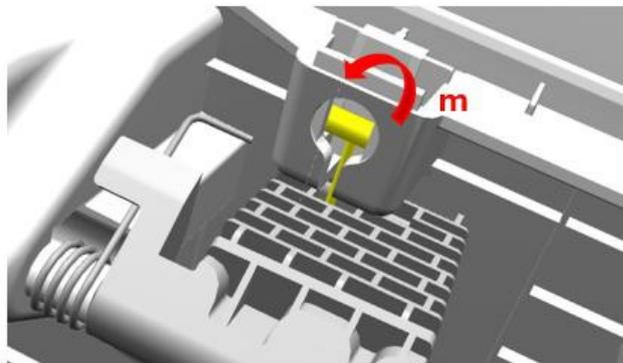
M : Tourner l'embout du câble (en jaune) dans la direction indiquée afin qu'il s'insère dans l'orifice prévu à cet effet.
