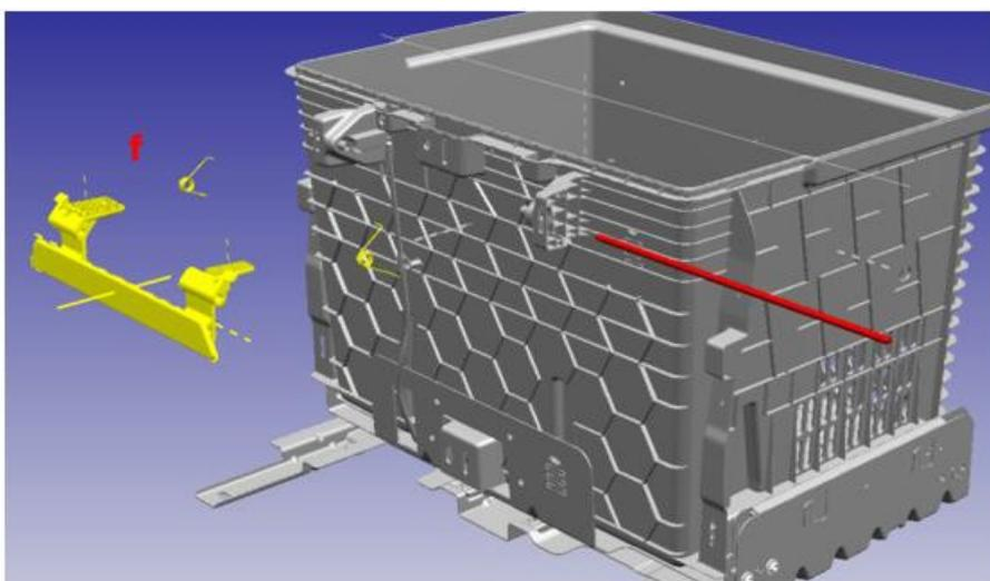
F : Dépose la poignée et le ressort en prenant garde de ne pas le faire chuter.
