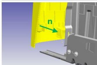
N: Durant l'installation du capot avant, veillez à ce que les clips s'insèrent correctement.
