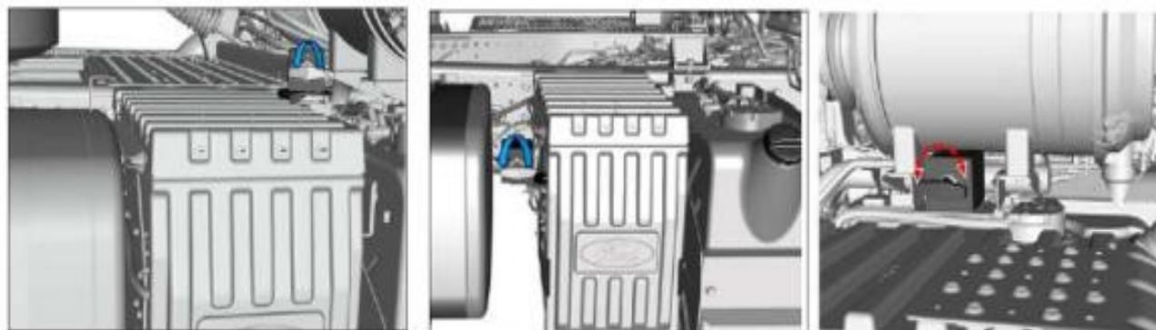
**Figure 2 : interrupteur principal de la batterie situé sur le châssis du véhicule**
