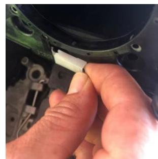
Retirez les connecteurs qui sont connectés à l'ensemble de boutons sur le volant.
