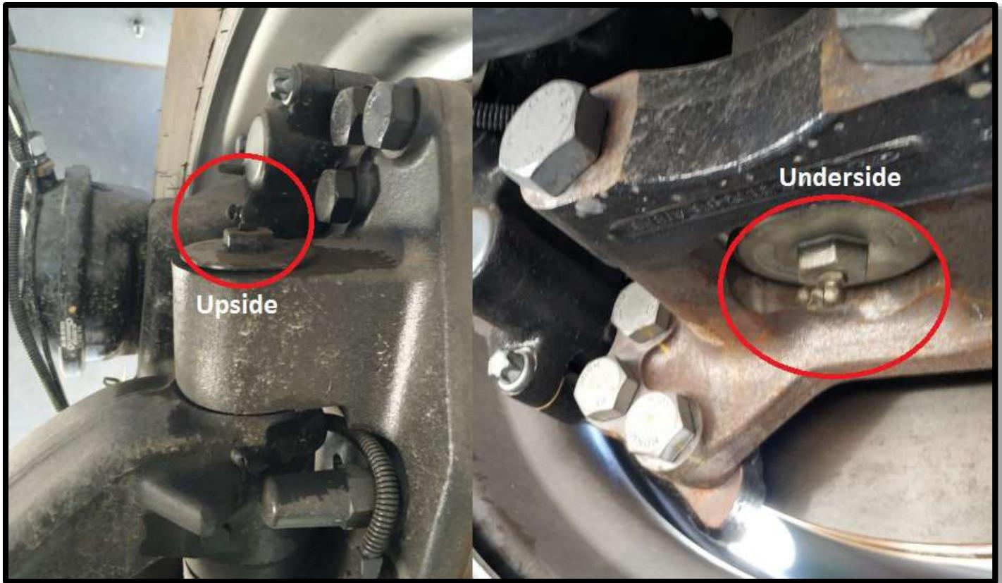
Mécanisme de verrouillage de la cabine
