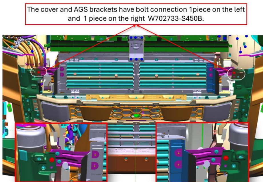
Figure 7 : Connexion entre l'AGS supérieur et la couverture parafoudre
