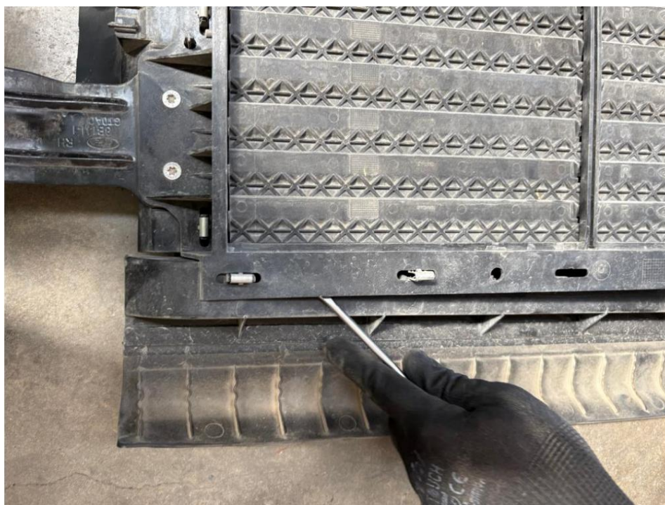
Figure 12 : Retrait des clips des pièces du conduit supérieur et du déflecteur d'air.
