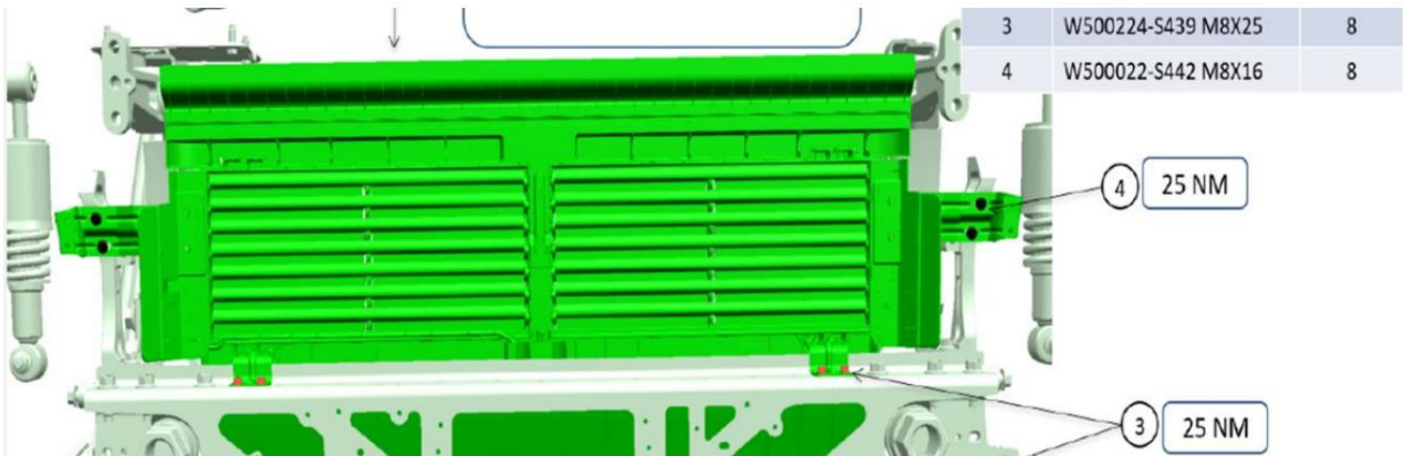
Figure 20 : Informations sur l'installation du support AGS supérieur
