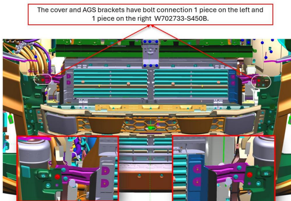
Figure 23 : Connexion du support AGS et du couvercle de protection contre la foudre
